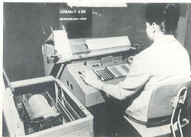
Bild 6. LOG ABAX Buchungsmaschine A 210 mit Programmtrommel
