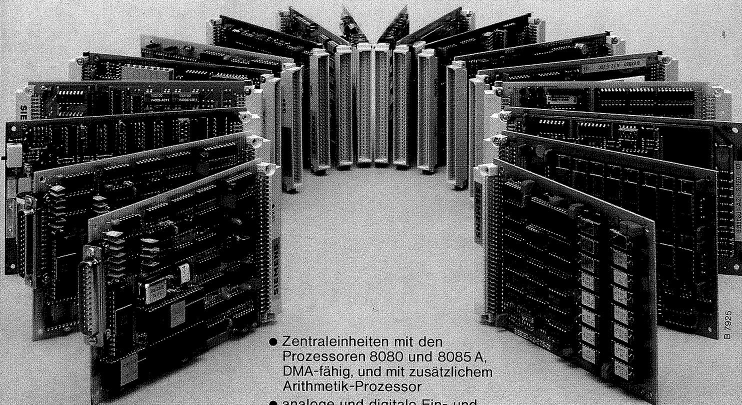
SMP 80 ist ein langfristig angelegtes, zukunftsicheres Mikrocomputer-Baugruppensystem von professioneller Qualität im Karten-Format 100 mm x 160 mm. Der große Vorteil für den Geräte-Entwickler liegt in der Vielfalt der Funktionseinheiten des Systems:
