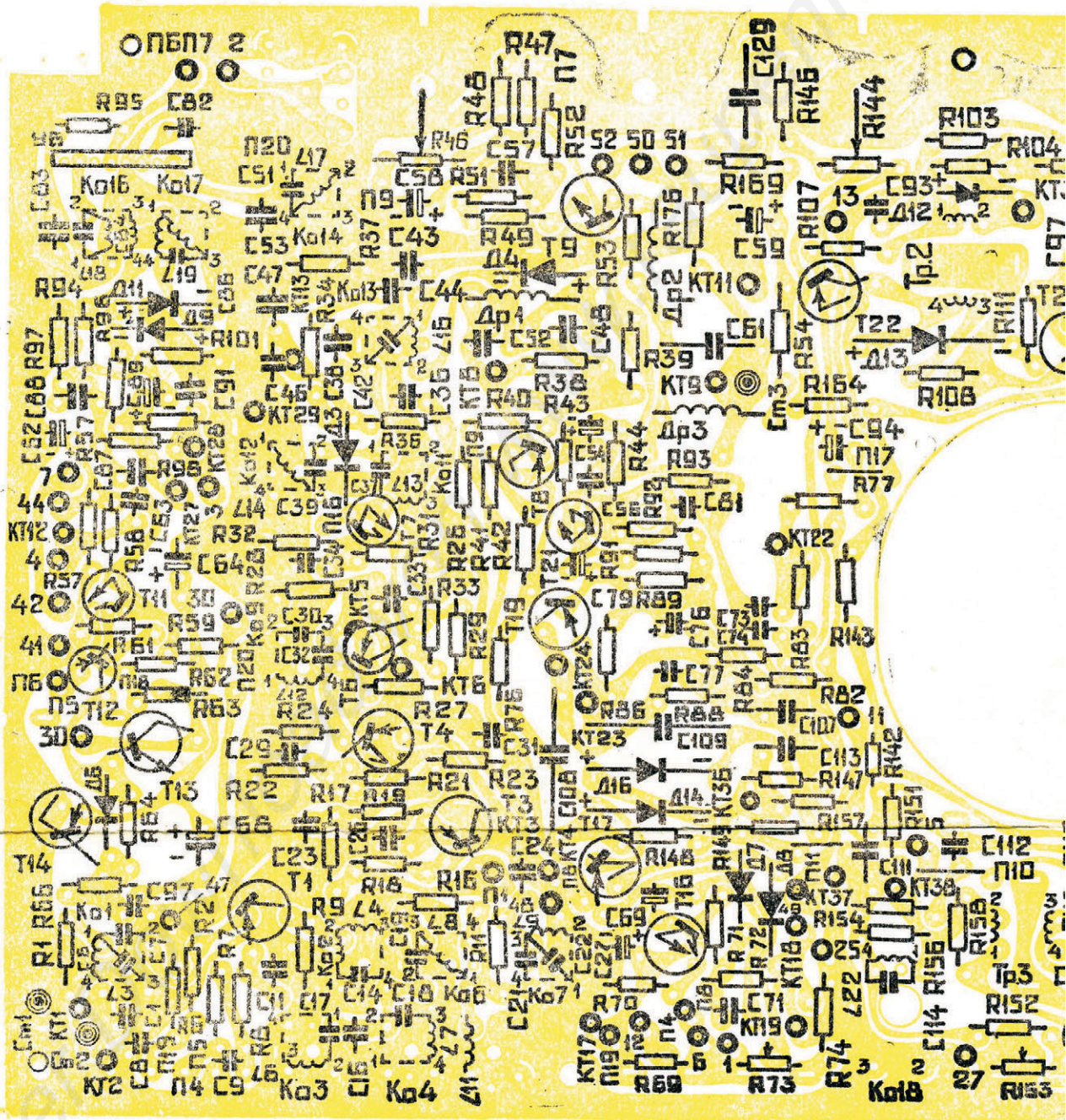
Схема расположения элементов и узлов на шасси телевизора «Юность-402 BE»
