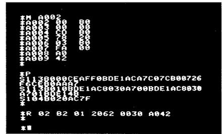
Bild 10. Beispiele für die M-, P- und R-Funktion des MIKBUG-Programms
