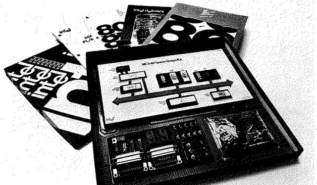
Den Aufbau eines vollständigen Mikrocomputer-Systems innerhalb weniger Stunden ermöglicht ein Bausatz der Firma Intel. Er enthält alle erforderlichen Bauelemente, den Mikroprozessor MCS 8080 und Software-Handbücher
