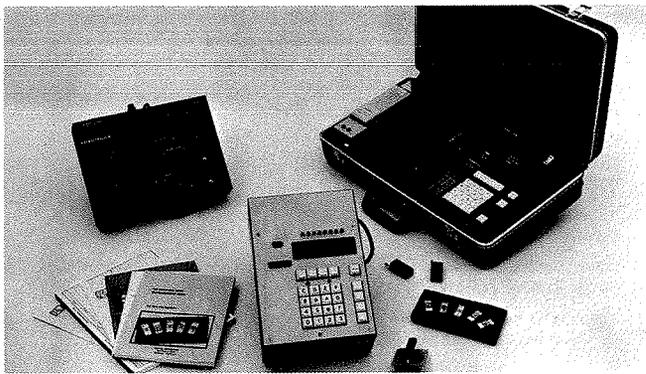
Dieses mikroprozessorgesteuerte PROM-Programmiergerät Modell 90 der Firma Pro-Log (BRD: Spezial Electronic, München) kann durch sog. Personality-Moduln alle gängigen Fabrikate programmieren (eine Übersicht von Firmen, die PROMs programmieren, finden Sie im „Elektronik-Markt“ auf Seite 104)
