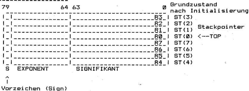
Die 8 Gleitkomma-Stackregister (R0...R7) des WM87 besitzen eine Breite von 80 Bits und sind in 3 Felder unterteilt:
