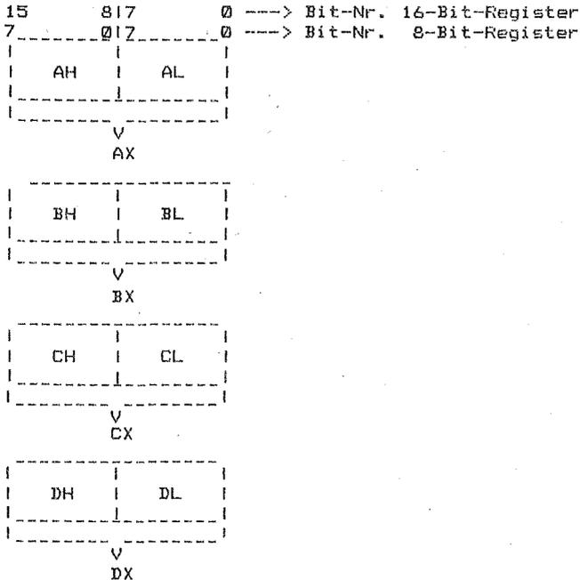
Durch die Aufteilung dieser 16-Bit-Register in 8-Bit-Register lassen sich 8-Bit-Operationen durchfuehren. Der Vorteil besteht darin, dass Operationen mit 8-Bit-Registern in der Regel weniger Zeit benoetigen. Ausserdem besitzen sie einen kuerzeren Maschinenkode als mit 16-Bit-Registern. Damit wird weniger Speicherplatz benoetigt.
