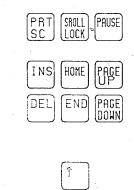
Diese Tasten werden durch die Umschalttasten nicht beeinflusst. Zu den Tasten fuer Einfuegen, Loeschen und Kursorpositionierung befinden sich auf der numerischen Tastatur gleichwirkende Tasten, wenn sie sich im Steuerzustand (NUM LOCK aus) befindet. Die Wirkung dieser Steuertasten kann in Anwenderprogrammen ggf. anders sein.
