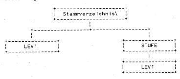
Durch das Kommando A>CD  $\TUFE\LEV1$  wird LEV1 zum aktuellen Verzeichnis.
