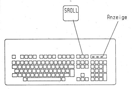
Nach dem Betaetigen von <SROLL LOCK> wird der Zustand 'SCROLL EIN' gesetzt (Anzeige SROLL LOCK leuchtet). `
