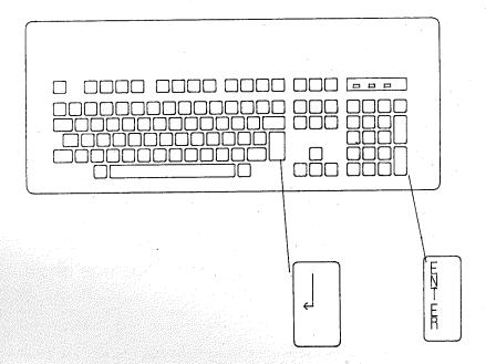
Die Starttasten wirken aehnlich der Taste <Zeilenschaltung> auf der Schreibmaschine. Der Kursor geht auf den Anfang der naechsten Zeile. Meist werden sie benutzt, um ein Kommando zum DCP zu senden oder eine Eingabe abzuschliessen.
