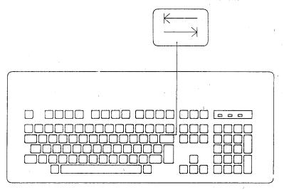
Mit der <Tabulatortaste> wird der Kursor auf die Position des naechsten Tabulatorstops nach rechts (in Zustand Umschaltung nach links) bewegt. Ein Loeschen von Zeichen erfolgt nicht. Im Grundzustand befinden sich auf jeder 8. Position Tabulatorstops.
