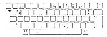
Zur Eingabe der rechts unten auf den Tasten abgebildeten Zeichen sind diese Tasten gleichzeitig mit <CTRL> und <ALT> oder mit <ALT1> zu betaetigen.
