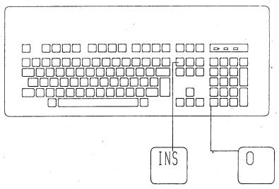
Mit <INS> wird der Einfuegemodus ein- oder ausgeschaltet. Im Einfuegemodus werden alle Zeichen rechts vom eingefuegten Zeichen um eine Position nach rechts verschoben.
