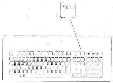
Diese Taste dient zum Anhalten eines Programms (z.B. zum Unterbrechen einer Bildschirmausgabe). Das Programm wird erst fortgesetzt, wenn eine andere Taste betaetigt wird.
