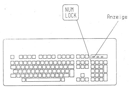
Wird die Taste < NUM LOCK> betaetigt, schaltet die Anzeige NUM LOCK ein und die Tastatur erhaelt ihre numerische Bedeutung. Mit einem erneuten < NUM LOCK> wird wieder in den Steuerzustand zurueckgeschaltet (Anzeige NUM LOCK aus).
