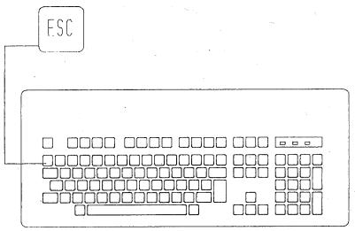
Die Taste <ESC> dient bei der Eingabe von DCP-Kommandos zum Loeschen von Eingabefehlern. Ihre Funktion in speziellen Anwenderprogrammen ist der entsprechenden Dokumentation zu entnehmen.
