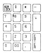
Die numerische Tastatur kann sich im numerischen Zustand (Anzeige NUM LOCK ein) oder im Steuerzustand (Anzeige NUM LOCK aus) befinden.
