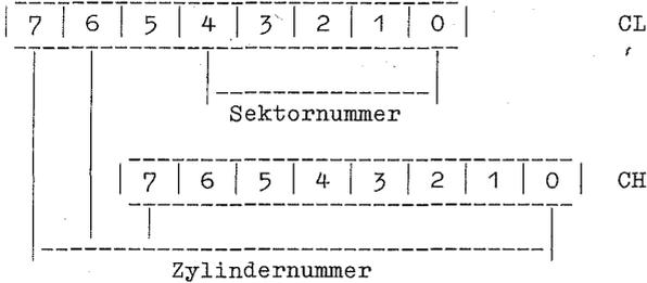
Der Sektor wird durch die Bits 4-0 von CL adressiert. Bit 7,6 sind hoechstwertigsten Bits der Zylindernummer.
