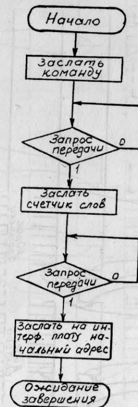
Рис. 15 Алгоритм программ "Запись, чтение буфера" при работе интерфейсной платы в режиме прямого доступа.
