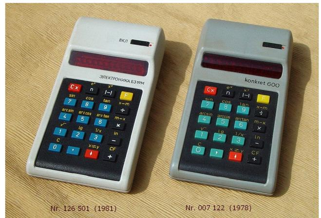
Äußerlich unterscheiden sich beide Taschenrechner nur durch den Typaufdruck und das Typenschild auf der Unterseite. Da der gleiche Schaltkreissatz verwendet wurde, ist auch die rechen-technische Funktionalität identisch:
