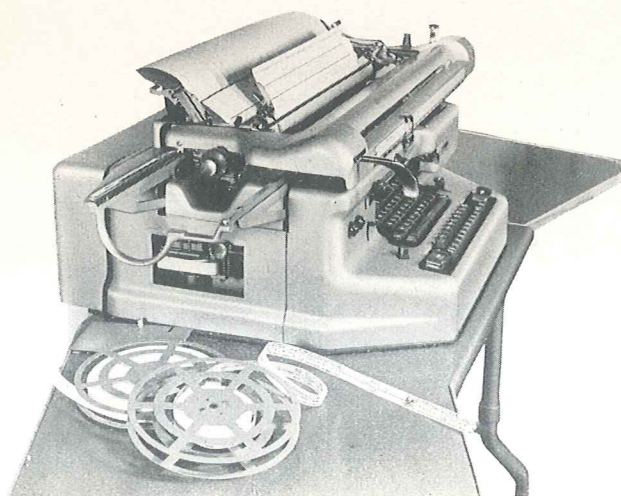
Bild 16. Mercedes-Buchungsmaschine SR 42 mit Streifenlocher (5-Kanalsystem)
