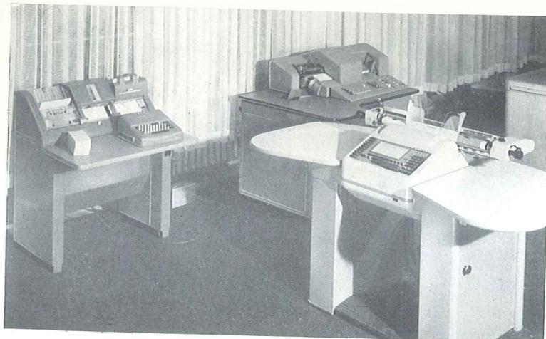
Bild 13. Kopplung des Buchungsautomaten mit Kartenlochern
