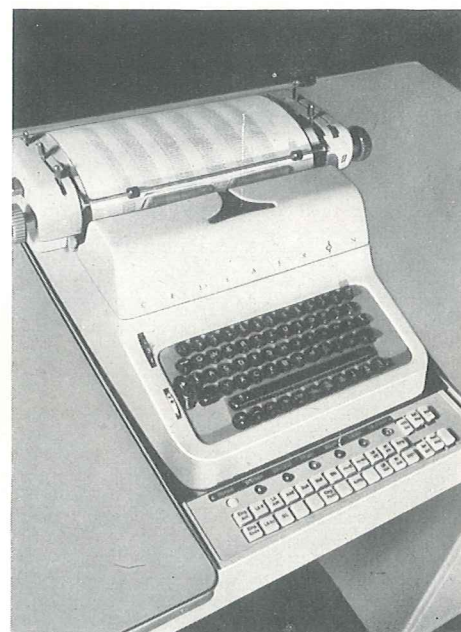
Bild 6 (oben). Soemtron-Tabelliermaschine mit elektronischer Multiplikation Robotron ASM 18
