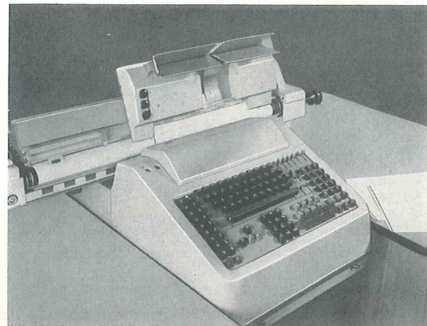
Bild 2. ASCOTA-Buchungsautomat Klasse 170 mit elektronischer Datenübernahme TS 36
