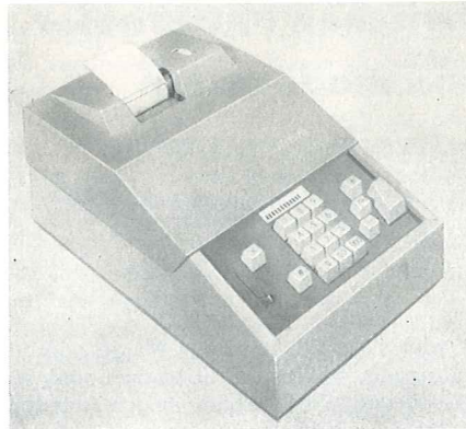
Bild 6. Ascota-Saldiermaschine mit vollautomatischer Multiplikation
