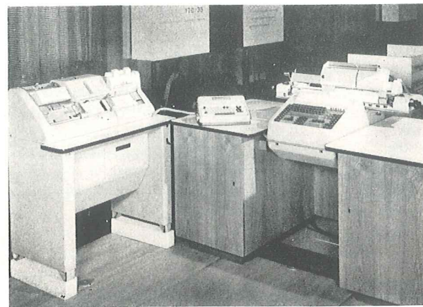
Bild 6. Ascota-Buchungsautomat Klasse 170 mit Lochkarten-Ein- und -Ausgabe
