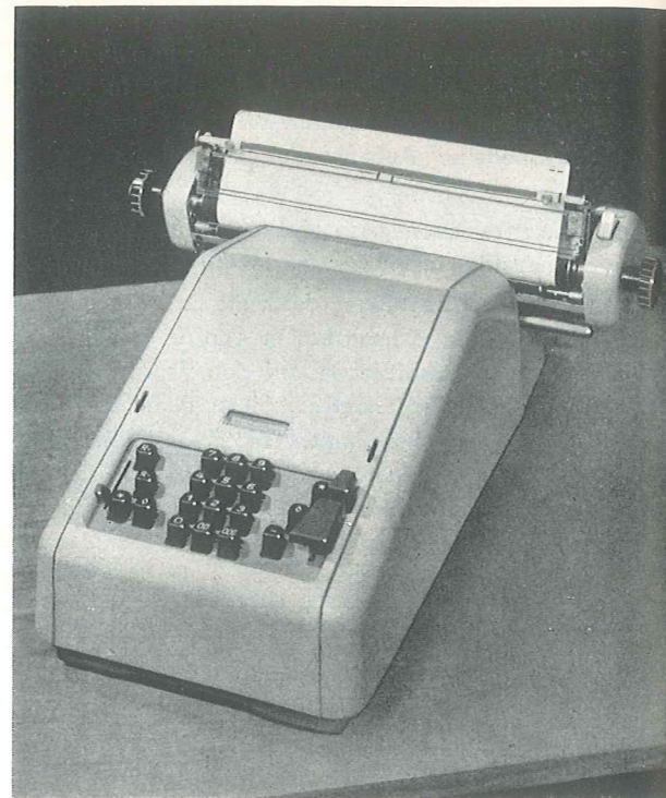
Bild 4. Optima M 14 mit Blindenschreibeinrichtung
