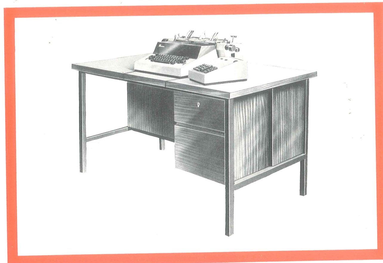
Bild 2. Organisationsautomat SOEMTRON 528 mit 8-Kanal-Locher, Ein- und Ausgabe
