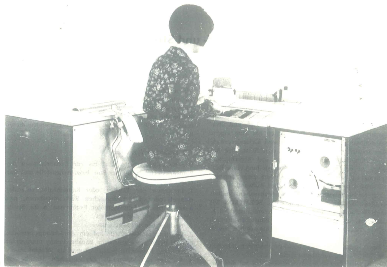
Bild 1. Magnetkonten-Computer ASCOTA Klasse 750 mit Lochstreifeneingabe und Leporelloeinrichtung
