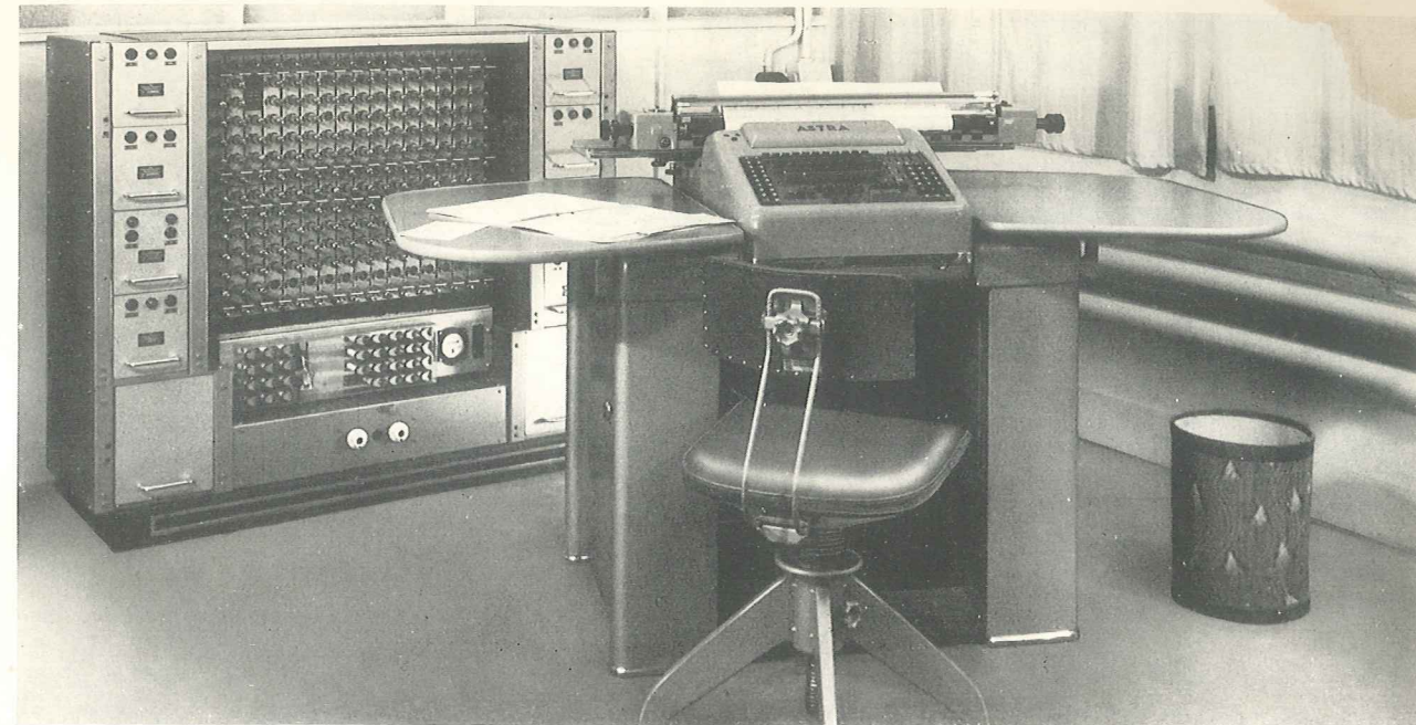
Abb. 6: 1959 Elektronisches Multipliziergerät R 12 für Buchungsmaschinen — 210 Röhren
