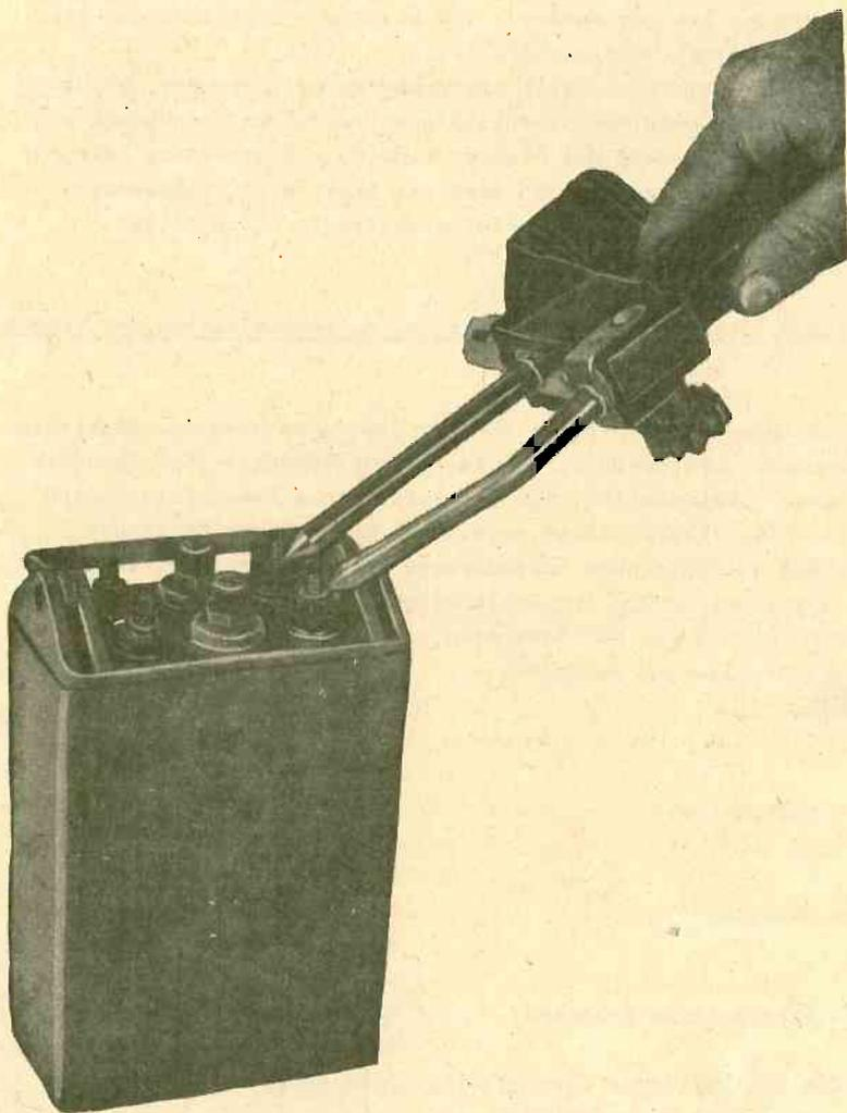
Bild B 3/5 Prüfen der Akkumulatorenspannung mit dem Akkumula-
