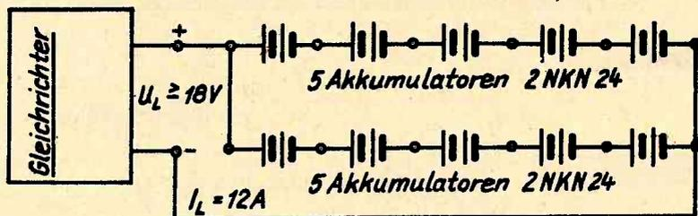
Bild B 2/4 Parallelschaltung gleicher Gruppen zum Laden
