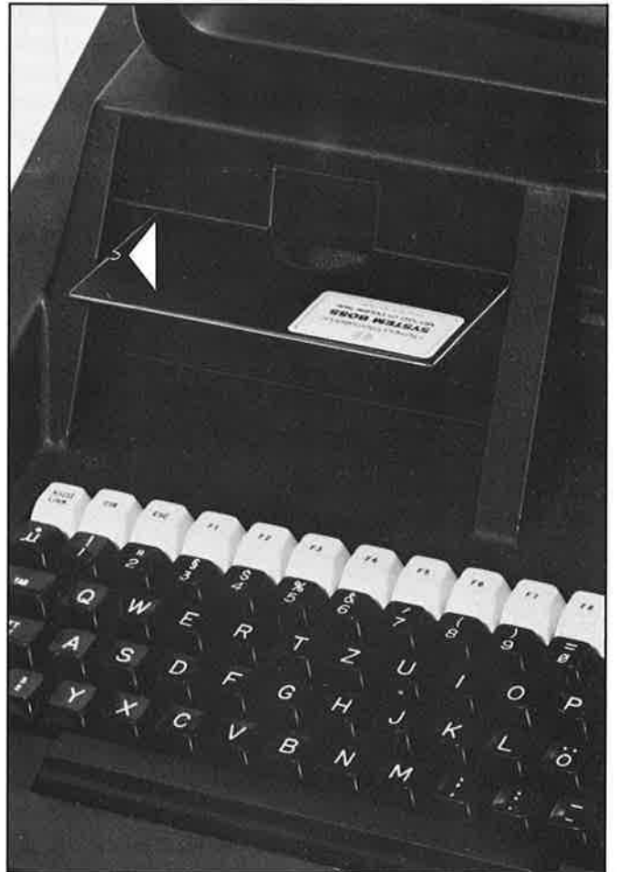
Abb. 3 Mikrocomputersystem Boss mit Diskette in richtiger Einschublage.
