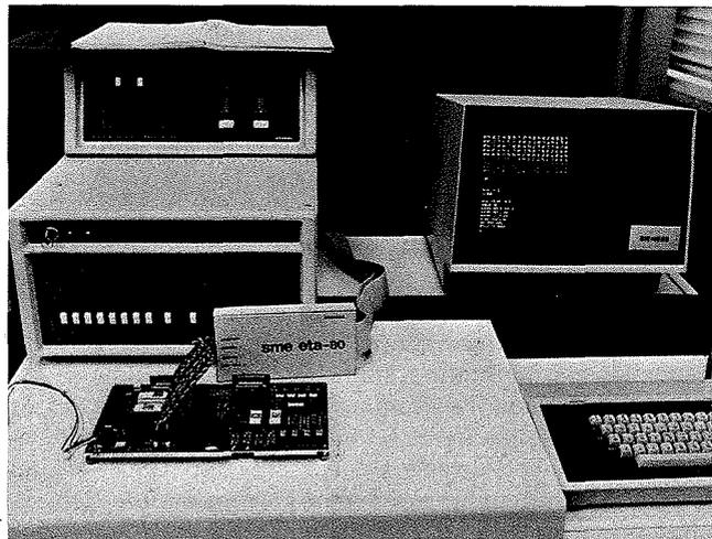
Bild 3. Das Entwicklungssystem SME-800 der Firma Siemens ist umfassend ausbaufähig und erlaubt den Anschluß aller herkömmlichen Peripheriegeräte
